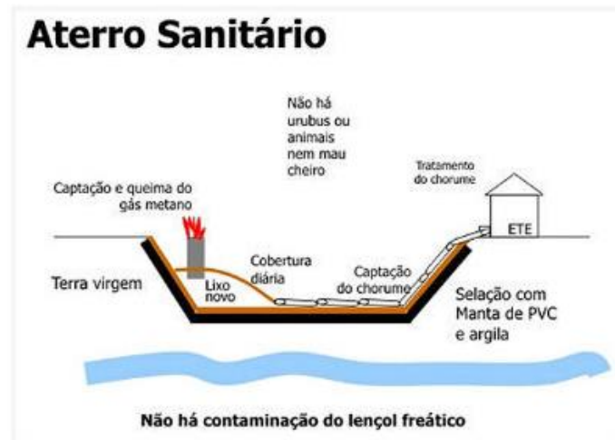
Figura 3: Estrutura de um Aterro Sanitário
